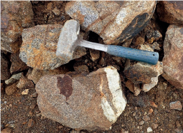
Abb. 37: Mehrere lose Glimmerit-Brocken, mit feinen, limonitisierten Rissen, am Glimmerit-Aufschluss (Estwing-Fäustel als Maßstab). Man beachte in dem Brocken im Vordergrund die Verzahnung von Glimmerit und dem weißlichen granulitischen Gestein. Granulit-(Serpentinit-)Steinbruch nördlich des Steinhof bei Karlstetten, Niederösterreich. Foto E. Löffler im September 2022
