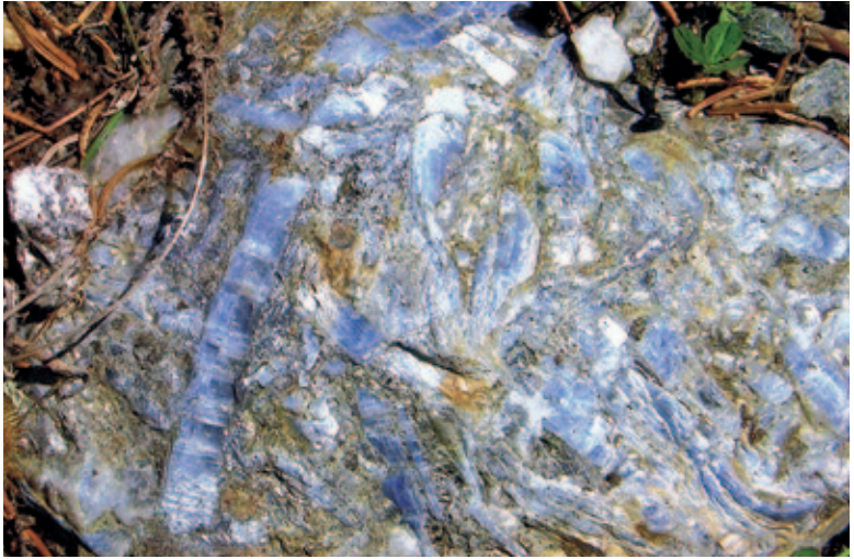
Abb. 30: Rollstück mit bis 5 cm langen, intensiv gefärbten Kyanit-Stängeln aus dem Hinteren Kendlbruckergraben im Lungau, Salzburg. Sammlung und Foto: M. Brunnthaler
