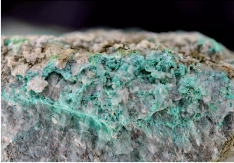
Abb. 25: Blassblaugrüne, feinkristalline bis pustelförmige Antleritkrusten als Sekundärprodukt der Kupfererze vom Bergbau Hochfeld im Untersulzbachtal, Salzburg. Bildbreite 3,2 cm. Sammlung: NHM Wien. Foto: H. Schillhammer
